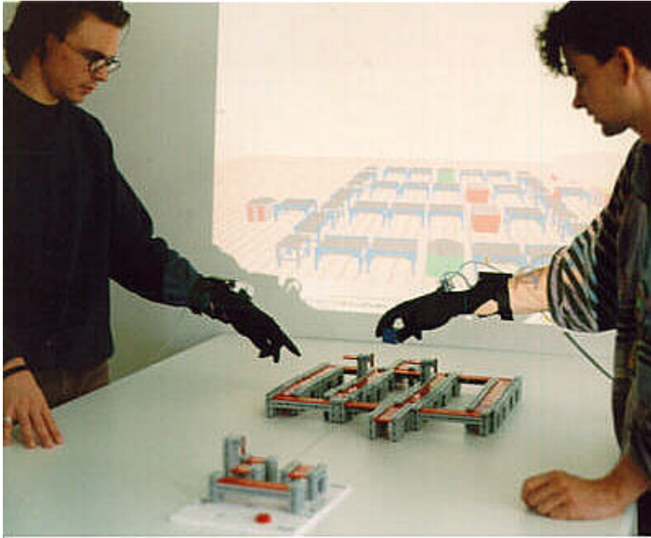
Bild 3: Aufbau eines Anlagenmodells. Mit beiden Datenhandschuhen können Twin-Objects aus der im Vordergrund dargestellten Object-Box entnommen und in das Modell eingefügt werden. In der Object-Box erhalten die gegenständlichen Modellbausteine eine definierte Initialposition, bevor sie in das Modell eingesetzt werden. Im Hintergrund ist ein virtuelles Abbild der Szene zu erkennen.
